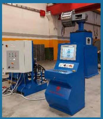
LINEAR LOAD THRUST TEST
